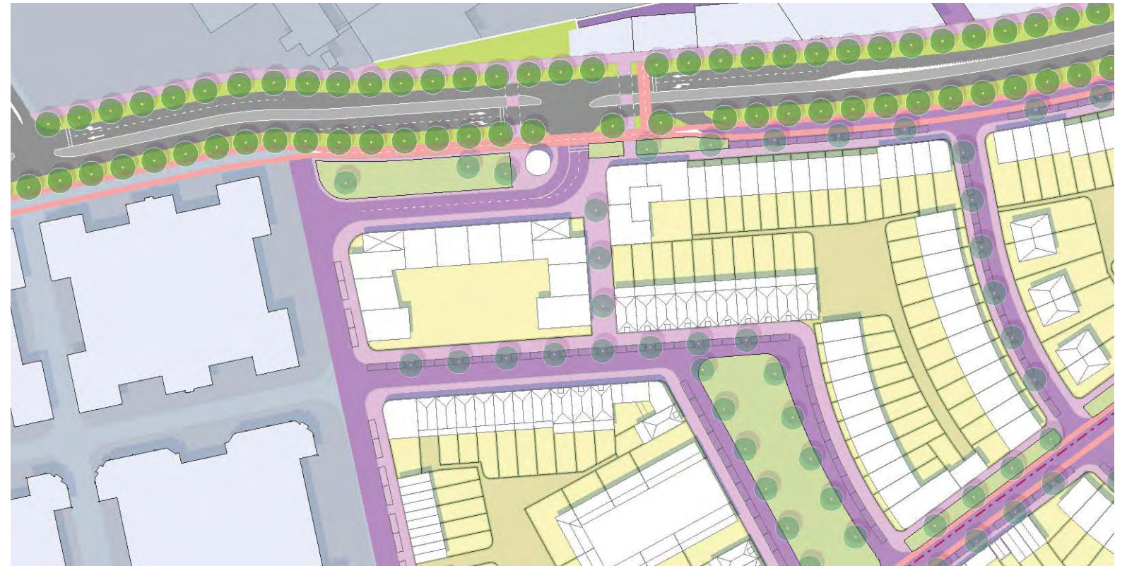
Figuur 7.2 Het nieuwe kruispunt met verkeerslichten dat zowel de ontsluiting van het bedrijventerrein (Henley) als de woonwijk regelt. Deze uitwerking illustreert dat er voldoende ruimte is voor fietsoversteekplaatsen. In het geval dat de nieuwe bedrijvigheid aan de noordzijde van de Verlegde Bosdreef op een andere wijze wordt ingevuld kan hier een verbinding met de ontsluiting van de metaalbedrijven worden gerealiseerd
